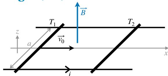
L'ensemble est plongé dans un champ magnétique uniforme et constant  $\vec{B} = B\vec{e}_z$ .
