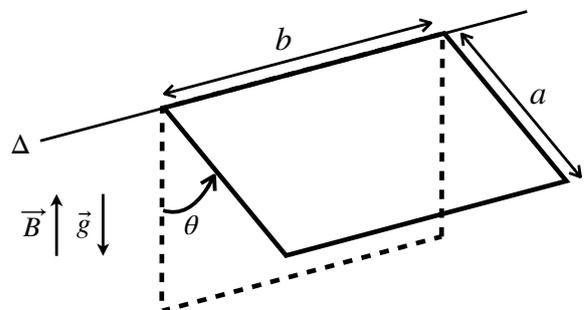
Les champs magnétique et de pesanteur sont supposés uniformes et constants. On écarte le cadre de sa position d'équilibre verticale (repérée en pointillés sur le schéma) d'un angle  $\theta_0$  puis on le lâche sans vitesse initiale.
