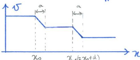
3. Si l'on fait la différence entre la vitesse finale ( $v_0$ ) et la vitesse initiale ( $v_0$ ) on trouve:  $\Delta v = -\frac{2a}{T} = -\frac{2a^3 B^2}{mR}$
