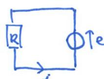
3. La puissance dissipée par effet Joule s'exprime  $P_J = R i_{\text{ind}}^2 = \frac{\pi^2 r^4 \mu_0^2 n^2 w^2 I_0^2}{R} \sin^2(\omega t)$
