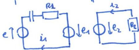
$$\text{où } e_1 = - \frac{d\phi_1}{dt} \text{ avec } \phi_1 = \text{flux à travers } (g_1) \\ = \phi_{1+1} + \phi_{2+1} \\ = L_1 i_1 + n i_2$$
