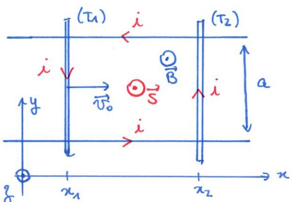
Ces observations sont cohérentes avec la loi de Lenz : les forces de Lépice s'opposent au rapprochement de ( $T_1$ ) de ( $T_2$ ) (et donc à une diminution de surface).
