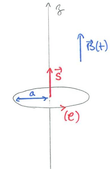
$$4. \text{ D'après l'énoncé: } \vec{B}_{\text{ind}} \propto i(t) \cdot \vec{e}_z = \frac{B_0 S \omega}{R} \sin(\omega t) \vec{e}_z$$
