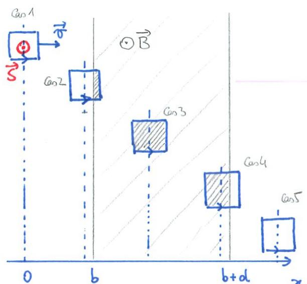
Avec la loi de Faraday, on en déduit la force dans le cadre, et avec un schéma équivalent on trouve  $i(t)$  le courant induit:
