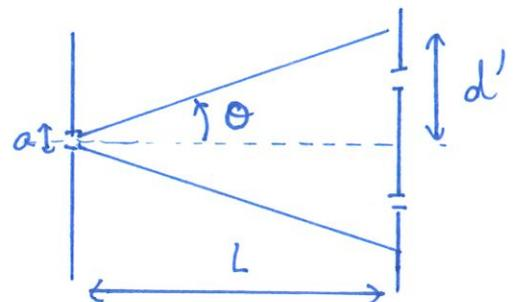
Or la double fente étant distante de  $L$ , la tâche de diffraction sur le plan des doubles fentes a une taille  $d' = L \times \tan \theta \approx L \theta$  car  $\theta \ll 1$
