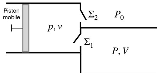
Le volume  $\nu$  maximal du corps de pompe est  $\nu_{\max}$ . On suppose que la température de l'air reste constante et égale à  $T$ . La valeur initiale de  $P$  est égale à  $P_0$ .
