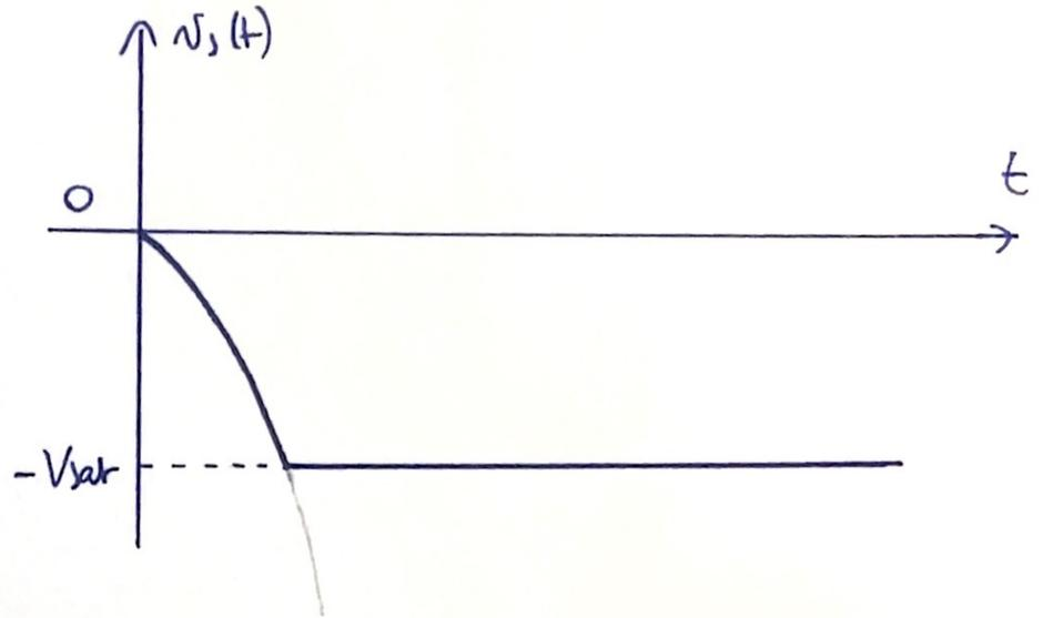
Remarquons que les résultats du fonctionnement linéaire prévu en régime permanent sont bien vérifiés lors d'une rétroaction négative (même si l'on peut avoir un régime de saturation). Ce n'est pas le cas lors d'une rétroaction positive, où le fonctionnement en régime linéaire n'est pas observé car le "régime transitoire" diverge et atteint exponentiellement un régime de saturation.
