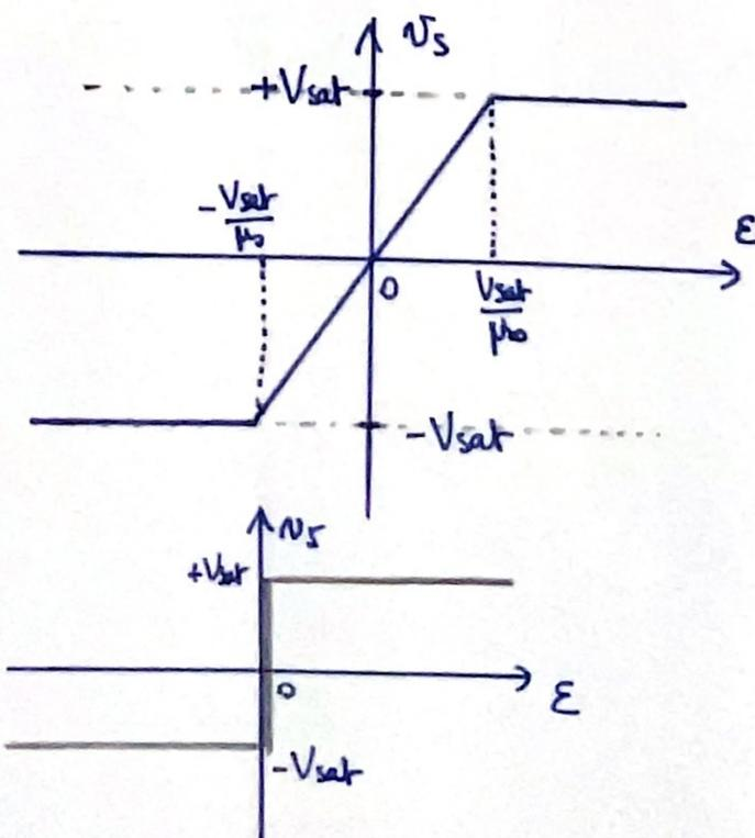
7. Comme  $v_s = \frac{E}{A}$ , pour avoir  $v_s \in [-V_{sat}, +V_{sat}]$ , il faut  $E \in [-A \cdot V_{sat}; +A \cdot V_{sat}]$
