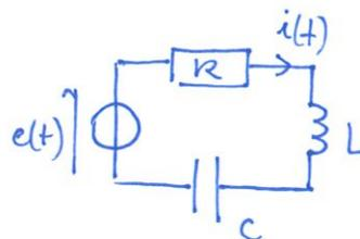
b) Il y a résonance au intensité dans le circuit si l'amplitude de l'intensité est maximale. Or si l'on note  $E_0$  l'amplitude de la tension imposée et
