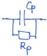
1.  $R_p$  et  $C_p$  sont en parallèle :  $\frac{1}{Z_{ep}} = \frac{1}{R_p} + \frac{1}{\frac{1}{jC_p\omega}} = \frac{1}{R_p} + jC_p\omega$
