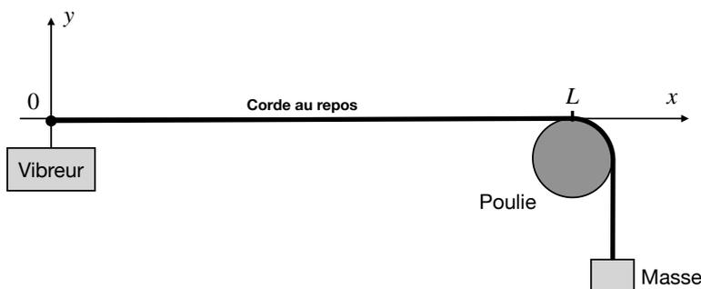
Initialement, la corde est horizontale et au repos. Pour certaines fréquences particulières d'oscillation du vibreur, une élongation  $y$  apparaît sur la corde sous la forme d'une onde stationnaire.
