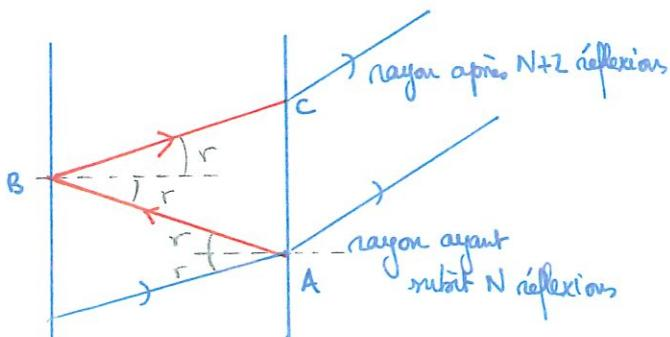
La différence de chemin optique entre deux rayons consécutifs correspond à la distance  $\delta = (AB + BC)n$  sur le schéma ci-dessus.
