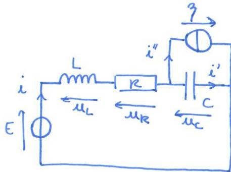
Par continuité du courant parcourant une bobine et de la tension aux bornes d'un condensateur :
