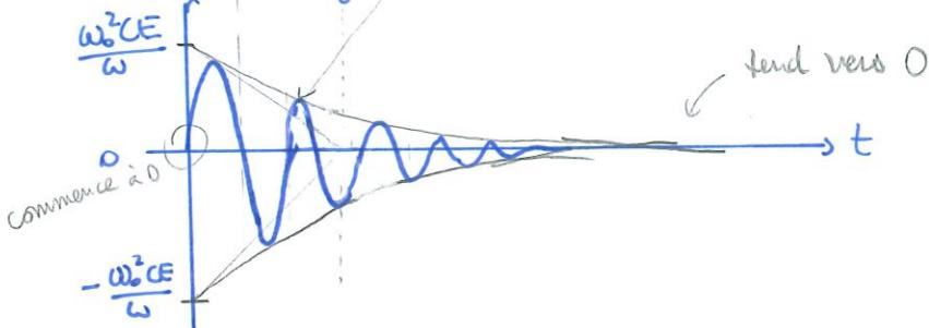
8. Pour déterminer  $\Delta E_C$  et  $\Delta E_L$ , on détermine l'énergie finale ( $t \rightarrow \infty$ ) ainsi que l'énergie initiale dans C et L.
