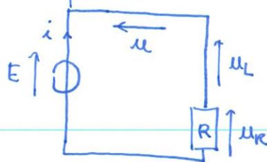
Lorsqu'on ouvre soudainement l'interrupteur (K), cela impose une discontinuité du courant dans le circuit. Or la bobine empêche une discontinuité du courant. Il apparaît une étincelle de rupture (cf TD Circuits du 1er ordre).
