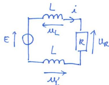
③  $t=0^+$ : si l'interrupteur est ouvert depuis longtemps, on peut considérer que toute l'énergie qui aurait pu être présente dans la bobine a été dissipée dans la résistance, donc  $i_2(t=0^-) = 0$  (et  $u(t=0^-) = 0$ ).
