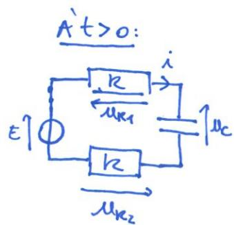
$\text{À } t \rightarrow \infty$ : - lorsque le régime permanent est établi, comme un condensateur se comporte tel un interrupteur ouvert, le courant ne passe pas dans le circuit:  $i(t \rightarrow \infty) = 0$
