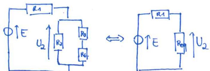
Calcul de  $U_2$  : on peut appliquer le pont diviseur de tension :  $U_2 = \frac{R_{\text{éq}}}{R_1 + R_{\text{éq}}} E$
