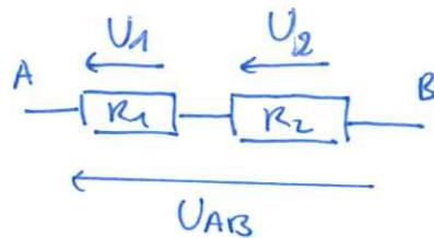
2. Ici, on souhaite appliquer un pont diviseur de tension. Pour cela, il faut faire "apparaître" deux résistances en série.
