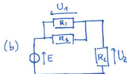
$R_1$  et  $R_3$  sont en parallèle, ils sont équivalents à  $R_{\text{éq}}$  avec  $\frac{1}{R_{\text{éq}}} = \frac{1}{R_1} + \frac{1}{R_3} \Leftrightarrow R_{\text{éq}} = \frac{R_1 R_3}{R_1 + R_3}$
