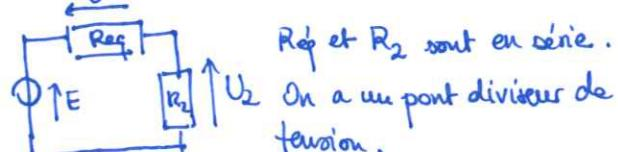
$$U_1 = \frac{R_{\text{éq}}}{R_2 + R_{\text{éq}}} E \approx 4,3V \quad U_2 = \frac{R_2}{R_2 + R_{\text{éq}}} E \approx 5,7V$$
