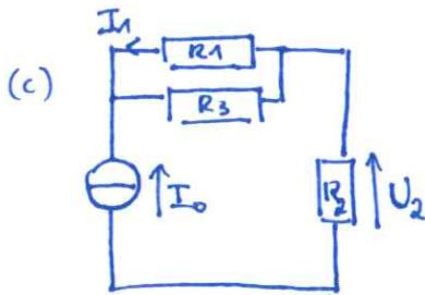
Ici, on ne va pas poser tête bêche dans le calcul d'une résistance équivalente par  $(R_1 \parallel R_3)$ , mais utiliser une loi des noeuds pour déterminer  $I_1$ .
