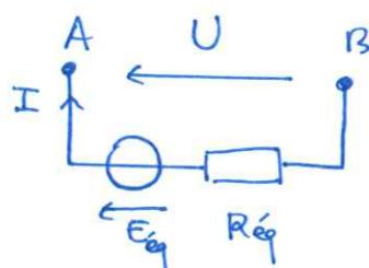
Ainsi le diôle AB se comporte bien comme une source réelle linéaire dont le modèle de Thévenin a pour caractéristiques  $E_{\text{eq}} = \frac{R_2}{R_1 + R_2} E$  et une résistance interne
