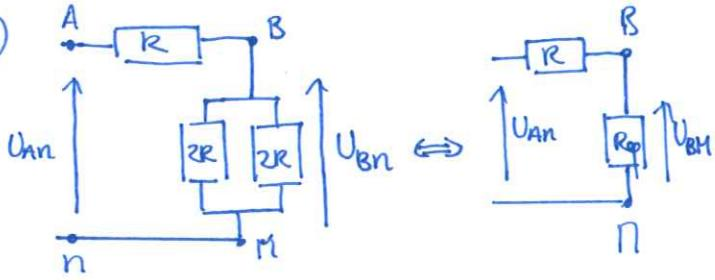
Finlement  $U_{Bn} = \frac{R_{\text{éq}}}{R+R_{\text{éq}}} U_{An}$  (on peut appliquer le pont diviseur de tension)
