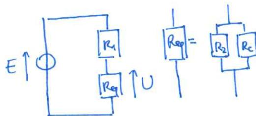
Finalement la formule du pont diviseur de tension donne:  $U = \frac{R_{eq}}{R_1 + R_{eq}} E$
