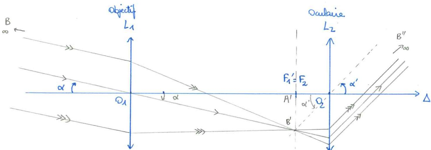
Pour tracer les rayons, commençons par le rayon  $\rightarrow$  passant par  $O_1$ . Il n'est pas dévié et permet de repérer le point  $B'$ , image de l'objet à l'infini par  $L_1$ , qui se situe dans le plan focal image de  $L_1$ . Les autres rayons, parallèles à  $\rightarrow$  avant  $L_1$ , convergent tous vers  $B'$  après la lentille  $L_1$ .
